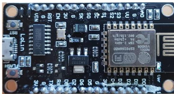
Gambar 1. NodeMCU ESP8266
